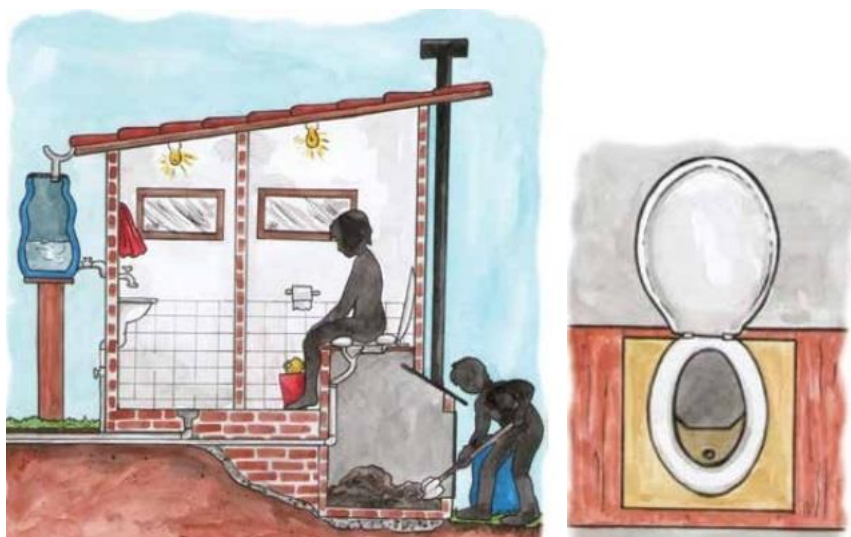
Figura 128 – Banheiro seco com bacia sanitária segregadora de urina
