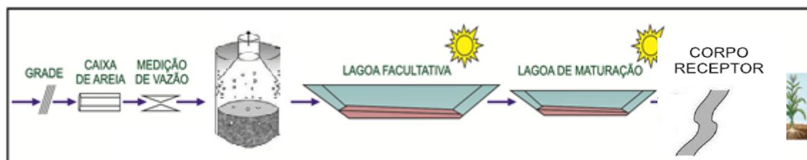
Figura 110 – Fluxograma típico de um sistema de tratamento com reatores UASB seguidos por sistema de lagoas
