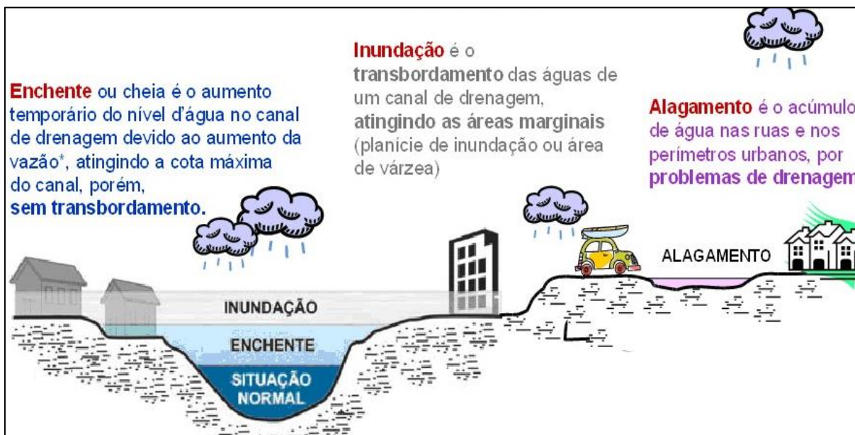
Figura 139 – Definição e ilustração de enchente, inundação e alagamento
