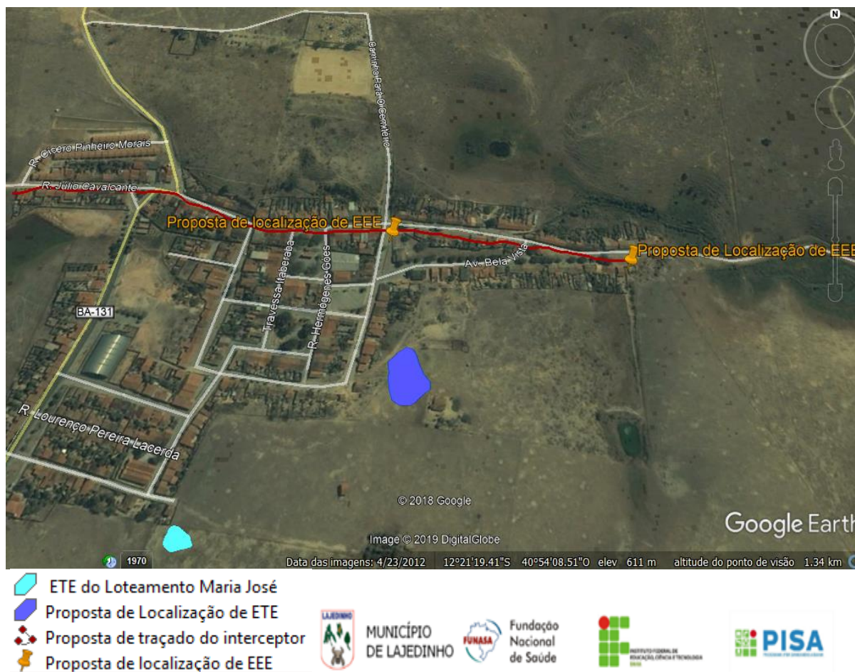
Figura 60 – Proposição de localização de ETE, EEE e Interceptor na Sede municipal de Lajedinho
