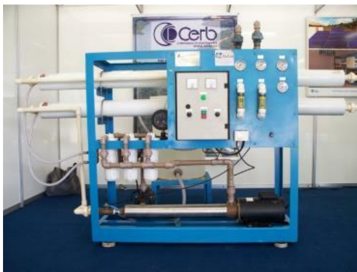
Figura 106 – Dessalinizador de água por osmose reversa
