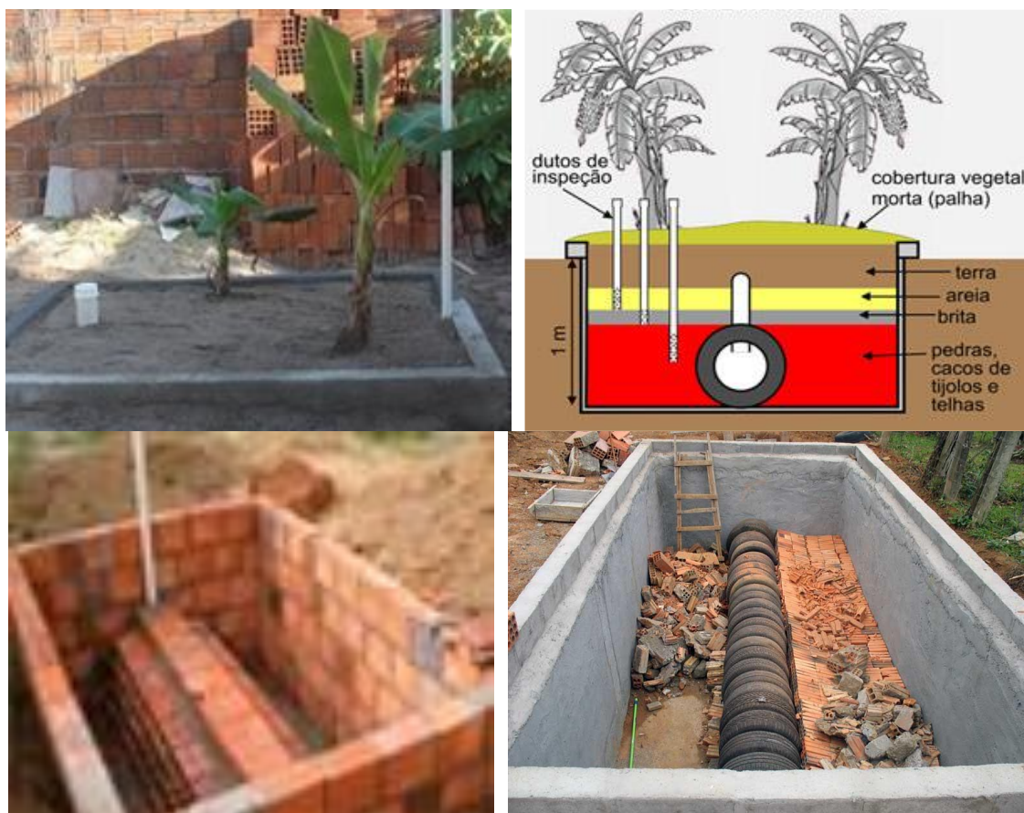
Figura 123 – Tanque de evapotranspiração
